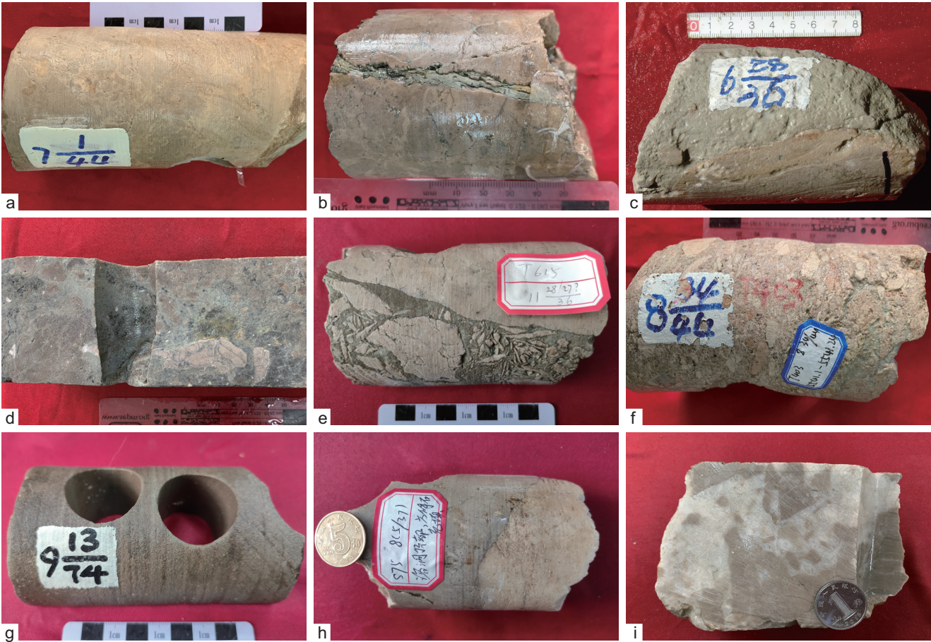
(a)T403 井, 7(1/44), 5504.4 m, 灰色亮晶砂屑灰岩, 未干扰围岩相; (b)T403 井, 6(22/36), 5487.4 m, 高角度裂缝, 缝内充填灰绿色砂泥, 裂纹化围岩相; (c)T403 井, 6(28/36), 5488.8 m, 灰色亮晶砂屑灰岩伴生方解石和灰绿色砂泥质, 渗流充填相; (d)T615 井, 7(4/35), 5521.6 m, 被灰绿色砂泥质胶结的细碎屑角砾岩, 角砾岩相; (e)T615 井, 11(27/36), 5559.2 m, 见高角度裂缝, 缝内被灰绿色砂泥质胶结粗碎屑角砾岩, 角砾岩相; (f)T403 井, 8(34/44), 5541.1 m, 见磨圆度较好的砾石, 灰绿色砂泥质胶结的角砾, 搬运型砾岩相; (g)T615, 9(13/74), 5542.7 m, 灰绿色石英砂, 搬运型砂岩相; (h) S75, 8(5/44), 5582.4m, 灰色亮晶方解石, 缝壁见巨晶方解石, 化学沉积岩相; (i)S65, 5732.7 m, 17(4/7), 巨晶方解石胶结角砾岩, 化学沉积岩相
