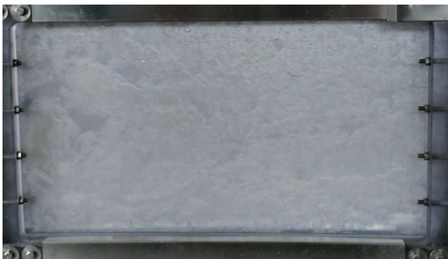
图6 封堵结束阶段裂缝内封堵情况
