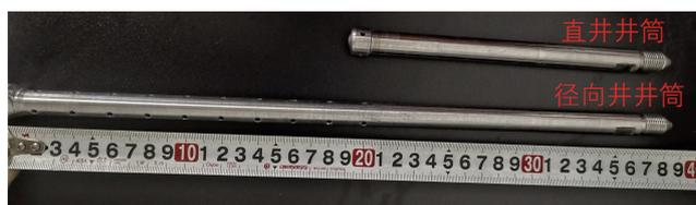
图6 直井井筒、径向井筒设计
