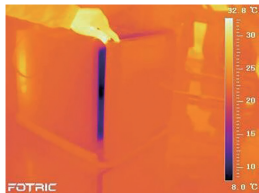
图5 红外热像下泄漏场景
