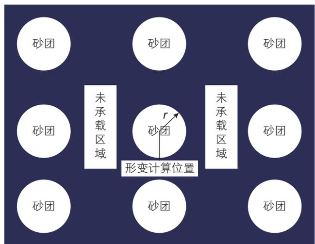
图8 平面裂缝形变计算示意图(砂团为圆形砂团)
