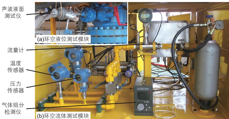
图 9 环空带压检测系统实物及现场连接图
