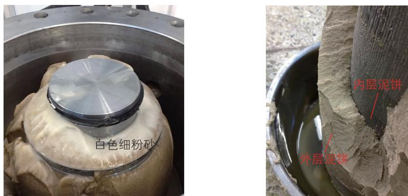
图5 实验筛管外泥饼断面图
